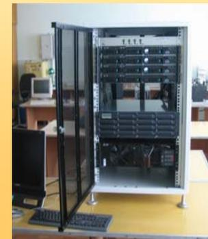
Персональные кластеры «СКИФ-Триада» обеспечивают пиковую производительность до 300-400 ГФлопс, имеют кластерную архитектуру, функционируют под управлением ОС Linux и Windows Computer Cluster Server 2003, используют в качестве среды параллельного программирования систему передачи сообщений MPI, языки программирования C/C++, Fortran.
