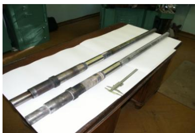
Рисунок 2 – Восстановленные валы (а) и шнеки насосов (б)
