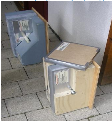
Рисунок 9 - Пример использования вакуумных теплоизоляционных панелей в стеновых конструкциях домов
