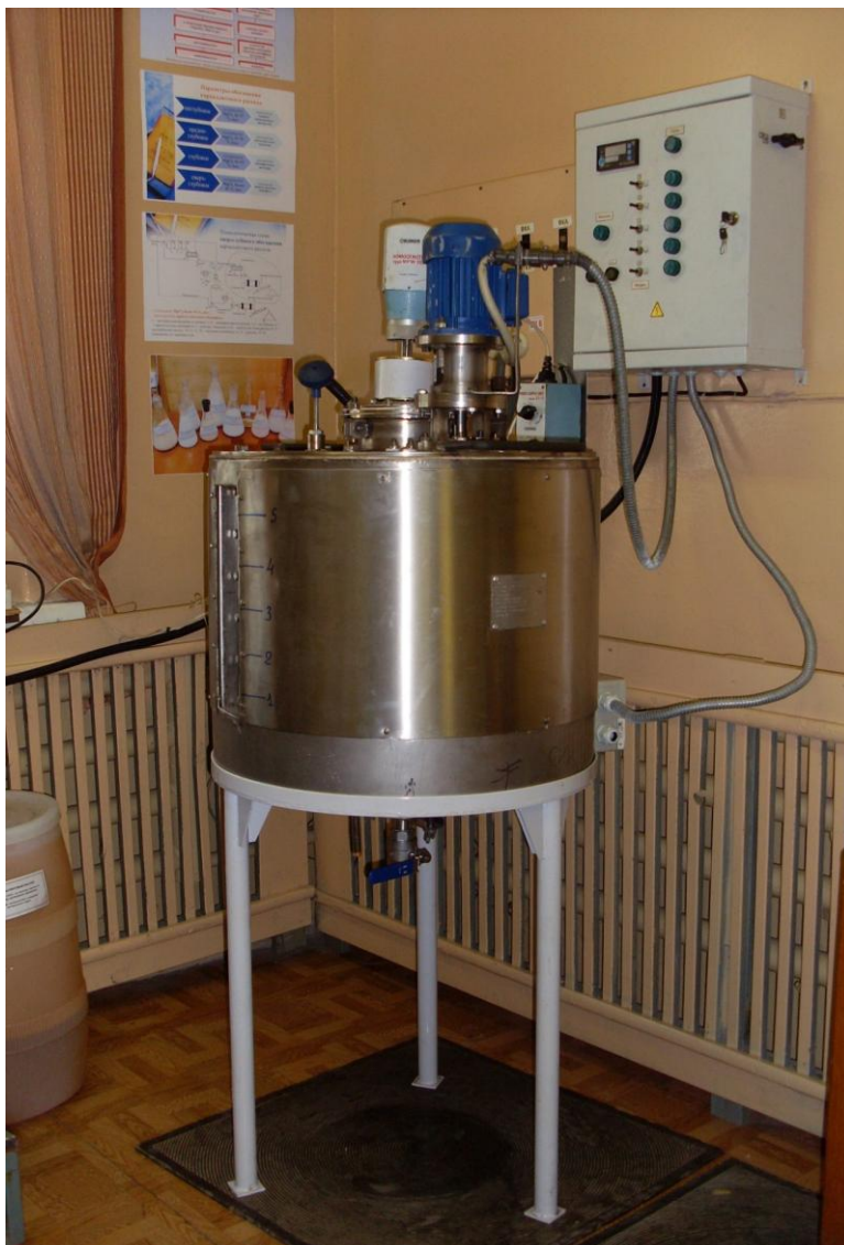
Рисунок 3. – Общий вид укрупненной лабораторной установки для упарки карналлитового рассола (реактора)
