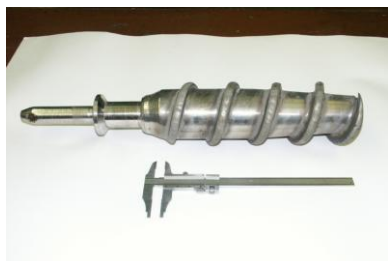
Рисунок 2 – Восстановленные валы (а) и шнеки насосов (б)
