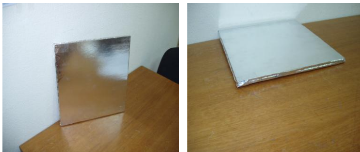
Рисунок 2 – Опытный образец вакуумной теплоизоляционной панели, разработанной ГП «Институт НИПТИС им. Атаева С.С.».
