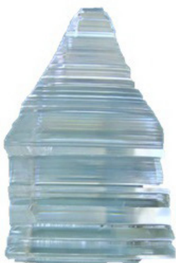
Фотоизображение монокристалла двойного вольфрамата KGd(WO_4)_2
