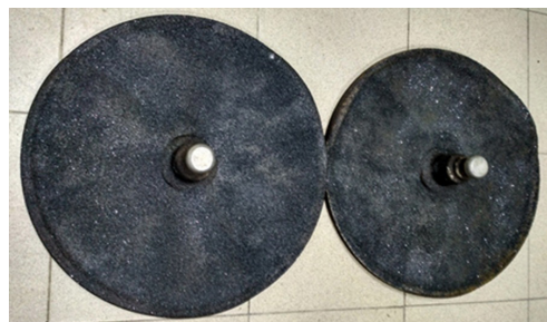
Обдирочные диски для очистки картофеля с композиционным покрытием «сверхвысокомолекулярный полиэтилен – карбид кремния»
