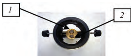
Акустический блок: 1 – датчик продольной волны; 2 – датчик поперечной волны
