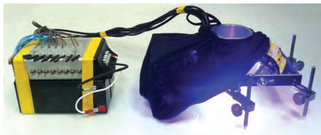
Устройство для освещения зоны контроля светодиодами при проведении люминесцентной капиллярной дефектоскопии
