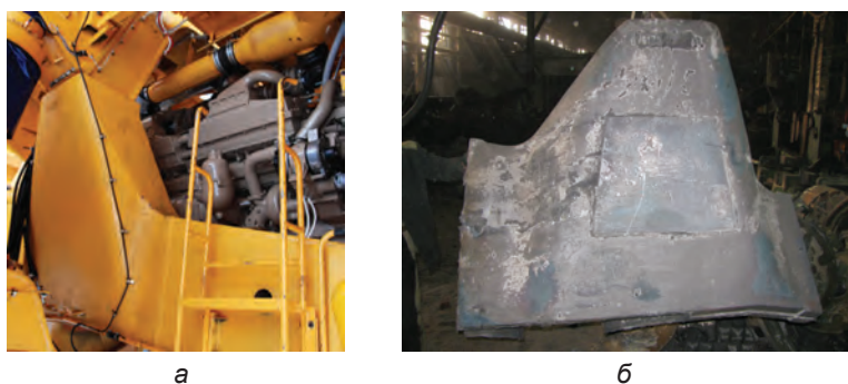
Рис. 2. Опора второй поперечины самосвала БЕЛАЗ: а – на машине; б – общий вид отливки поперечины
