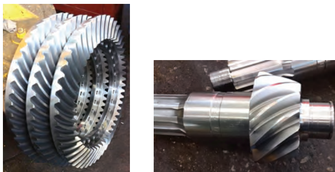
Рис. 1. Общий вид образцов зубчатых колес, полученных из новых конструкционных сталей
