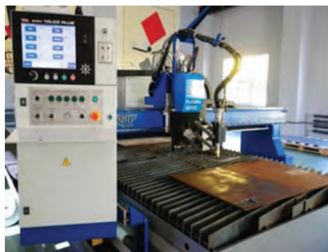
Рис. 2. Пятикоординатный манипулятор для плазменной резки под углом криволинейных поверхностей
