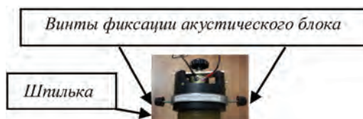
Фиксация акустического блока на шпильке
